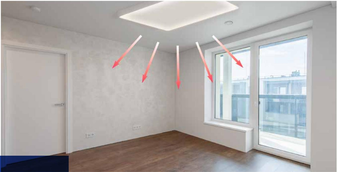
Wärmeverteilung bei der Nutzung von Infrarot-Wärmequellen
